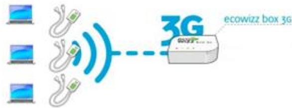
Figure 33. Illustration de l'enregistrement des données (solution Ecowizz) : ordinateur, prise d'enregistrement et box 3G
