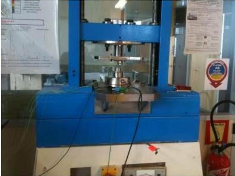
**Figure III-43 : Presse mécanique de 100 tonnes**
