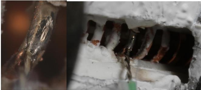
Figure IV-38 : Thermocouple sur l'hélice du 220W Ku
