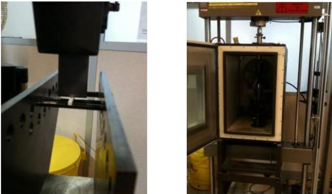
**Figure III-27 : Photos du dispositif expérimental pour la mesure de flexion 3 points pour les montants**
