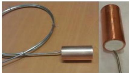
Figure IV-56 : Résistance chauffante finie
