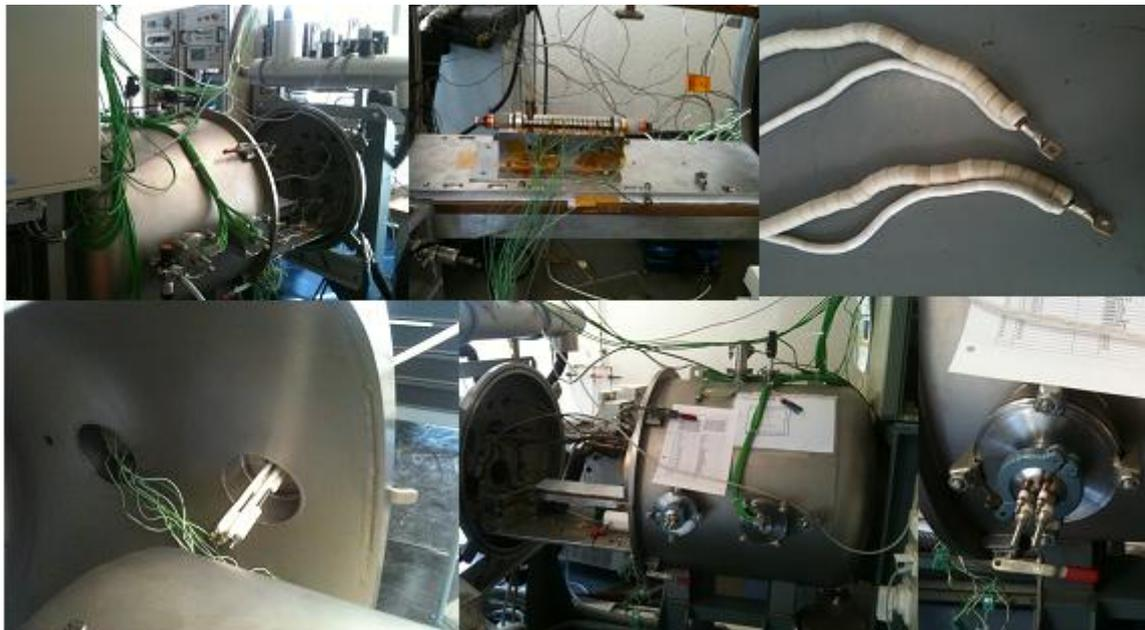
Figure IV-47 : Dispositif du Tube n°4 pour une mesure sous vide
