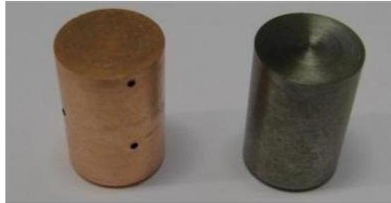
Figure III-48 : Photo des échantillons utilisés pour les mesures de RTC
