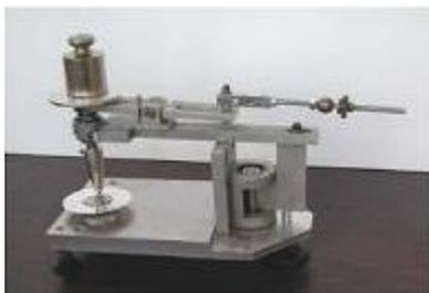
Figure III-10 : Montage d'indentation sphérique
