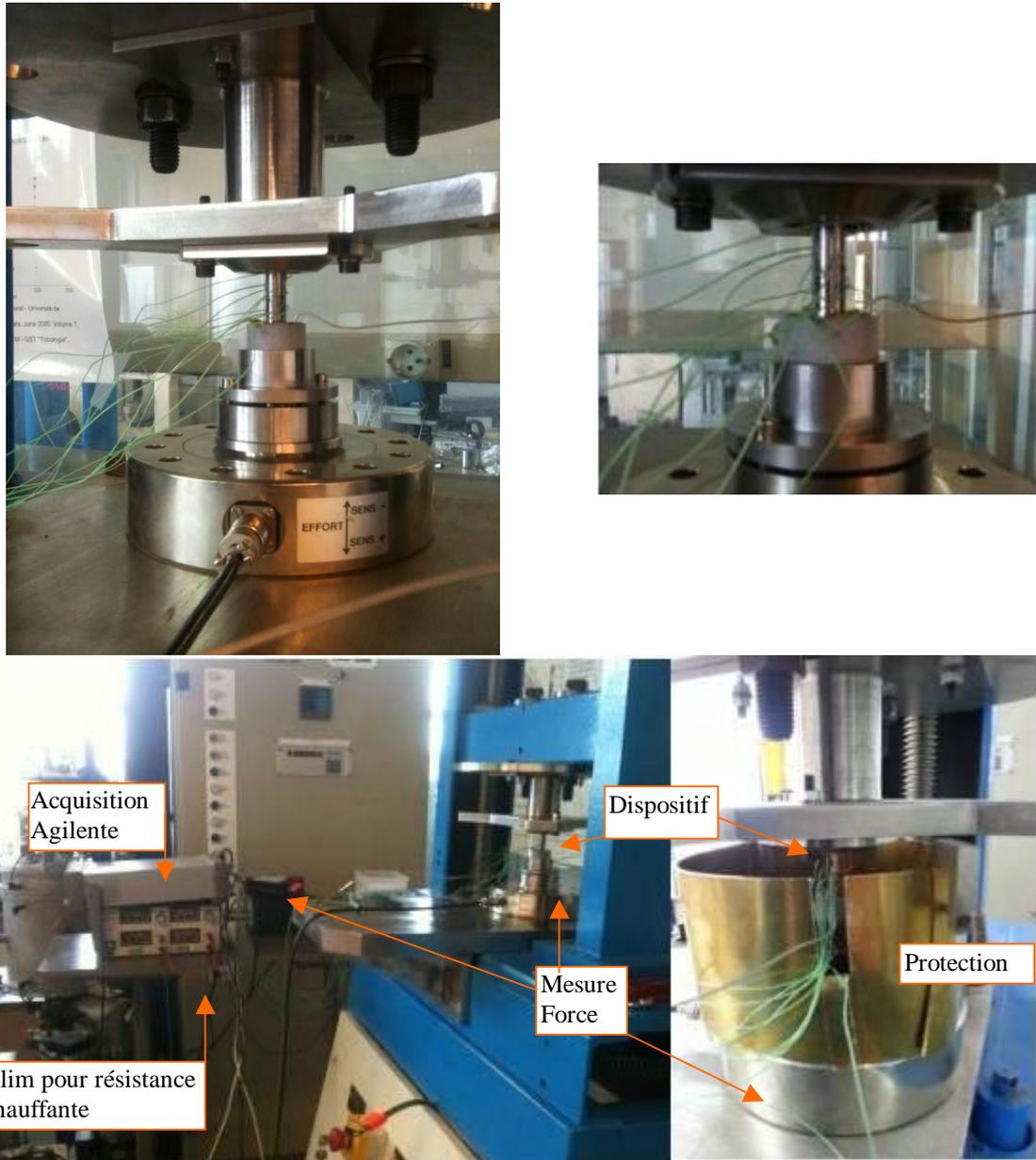
Figure III-42 : Dispositif expérimental de mesure de la RTC
