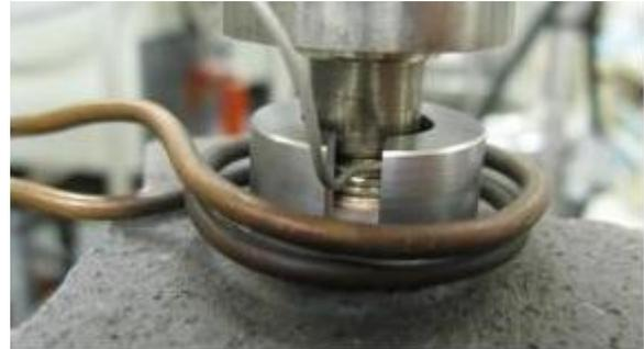
**Figure III-45 : Moyen de brasage de la résistance chauffante sur son support**
