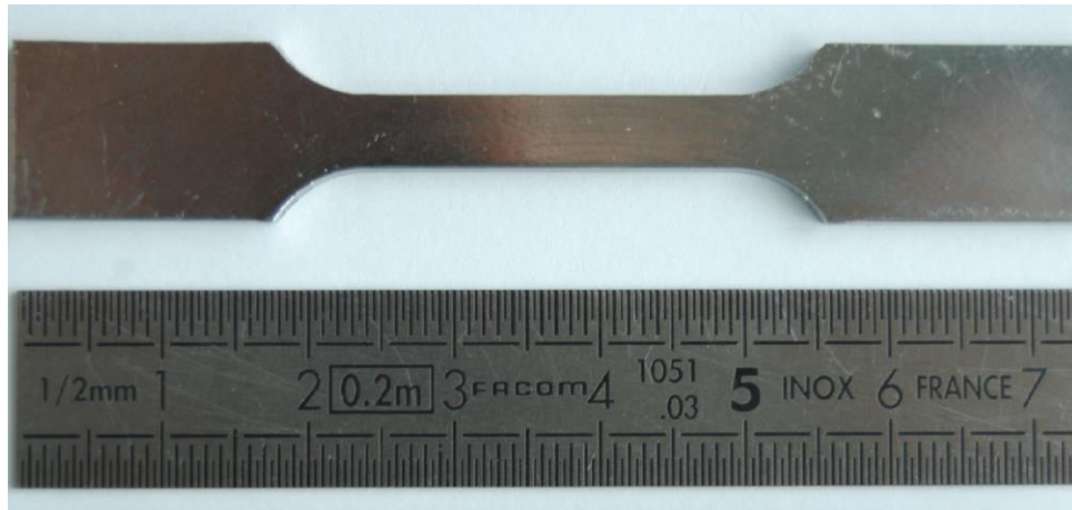
Fig.9. Le mini-échantillon pour l'essai de traction quasi-statique
