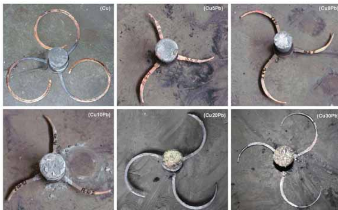
Figure 162 : exemples de spirales classées par teneur croissante en plomb
