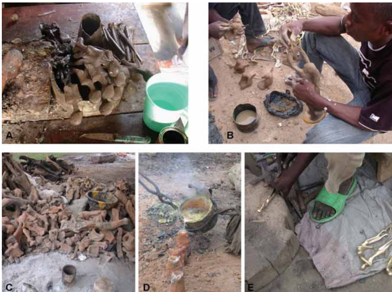
Figure 2 : fonte pleine par le procédé direct, village artisanal de Ouagadougou (Burkina Faso), mars 2008. A statuettes sculptées et modelées en cire ; B confection des moules de coulée ; C étuvage des moules autour d'un foyer ; D coulée du métal ; E statuettes en cours de finition.
