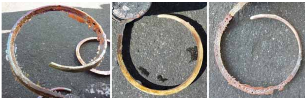
Figure 166: Comparaison de la qualité des coulées : cuivre non allié (à gauche), bronze (au centre) et cuivre au plomb (à droite).
