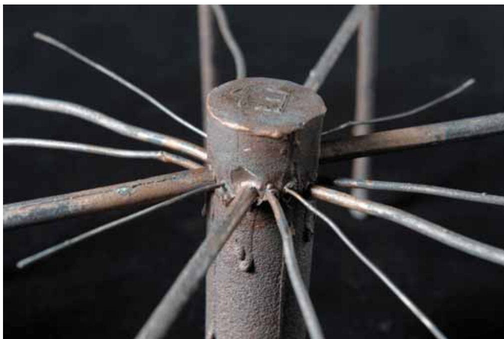
Figure 176 : détail de l'araignée de bronze n°13 après décochage du moule et sablage léger à la poudre de noyau d'abricot (Cu10Sn17Pb, \Delta T : +200°C, T_{\text{moule}} : 600° C).
