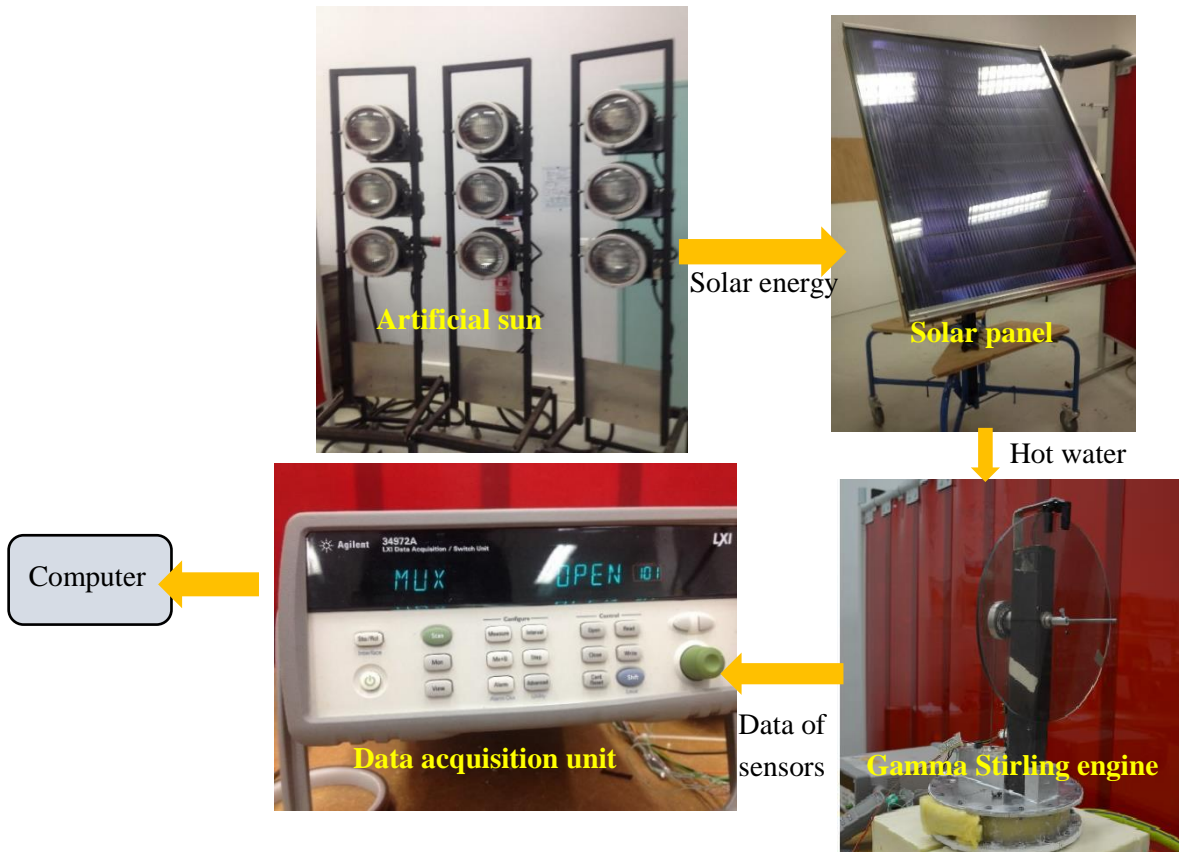
Figure 10 Banc d'essai de moteur Stirling de type Gamma à énergie solaire
