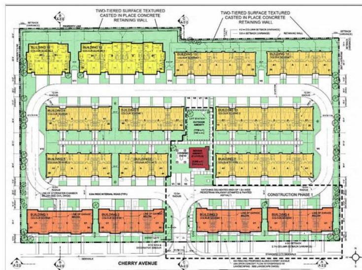
Figure 20 : Plan-masse du complexe Swallows Nest, à Honeydew Ridge, qui comprend 58 unités. Il s'agit d'un plan de masse typique des productions réalisées par le promoteur Genesis Projects pour ce type de produits immobiliers.
