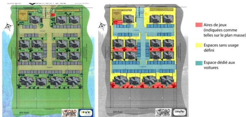
Figure 21 : Devion Place, Genesis Project, 2017. Ce plan masse est un exemple parmi tant d'autres de l'aménagement d'une parcelle par duplication d'un module d'habitation. © Karen Lévy, Mars 2018.
