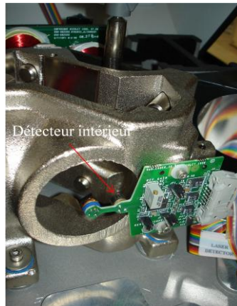
Figure (III-21) : Détecteur intérieur (PbSe) de spectromètre TF.
