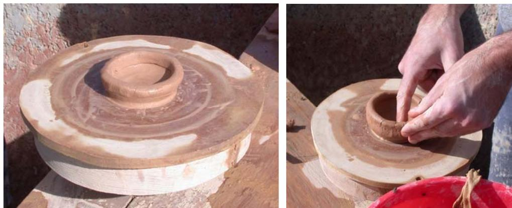
*Fig.71 : Pose et jointoyage des colombins.
