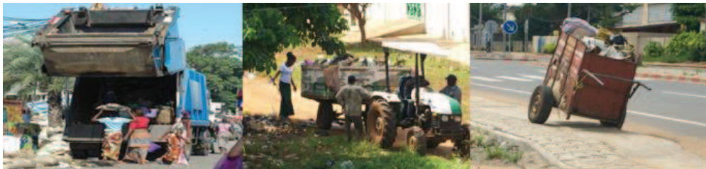
Engins de collecte de déchets. A gauche, voiture d'occasion destinée à la collecte à Cotonou. Au milieu, tracteur servant de collecte de déchets à Porto-Novo (ici les déchets ne sont pas couverts sur tout le trajet). A droite, poussette localement conçue servant de collecte primaire des déchets, il y a environ dix catégories. Photo n°20, I. A. Yaï du quotidien La Fraternité , du 26-01-2011 et M. Chabi
