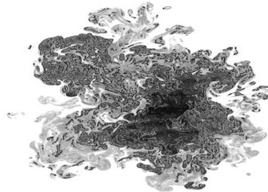
FIGURE 3.6 – Mesure 2D de la concentration d'un jet turbulent ( $Re \approx 9.10^3$ ) mesuré perpendiculairement à la direction du jet par fluorescence induite par laser, phénomène dont la dimension est dépendante d'échelle [Catrakis et Dimotakis, 1996]
