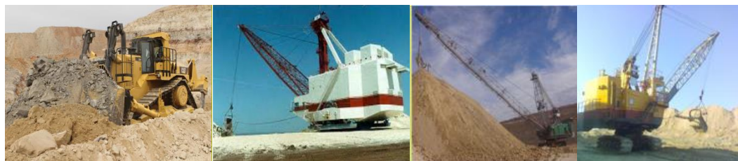
Figure 11. Machines de décapage : Bulldozer D11, Draglines 7500M, P&H, 200B.
