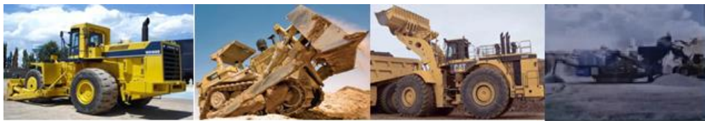
Figure 13. Machines de Défruitage : Paydozer, Bulldozers D9, Chargeuse, Cribleuse mobile.
