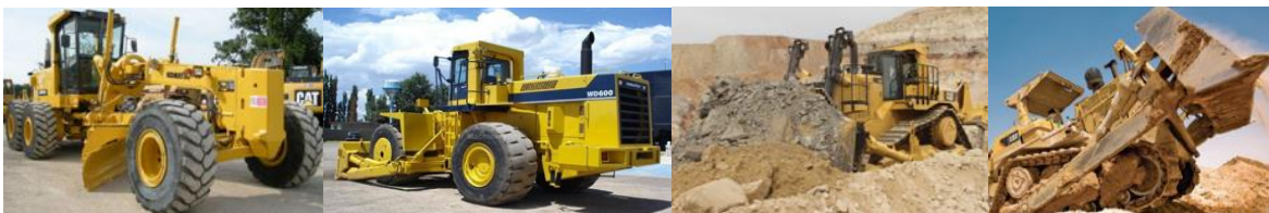
Figure 8. Équipements d'aménagement : Niveleuse, Paydozer, Bulldozer D11 et D9.
