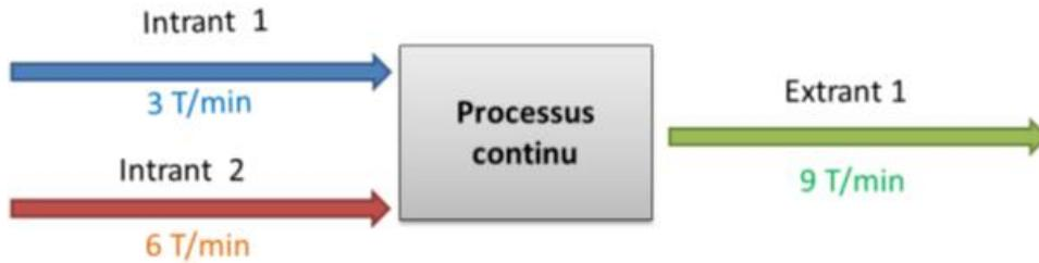
**Figure 32:** Exemple d'un processus continu
