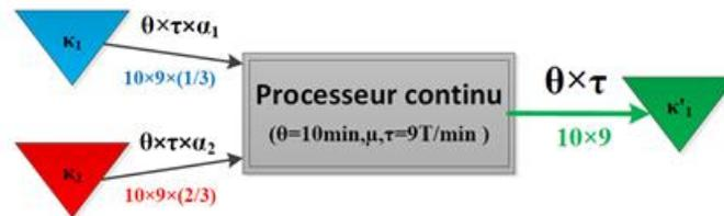
**Figure 40:** Utilisation de la primitive d'un processus continu (avec explicitation de nomenclature)
